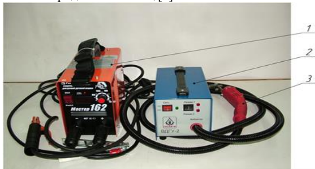
Рисунок 1 – Комплект оборудования для КВДУ: 1 – источник тока; 2 – пульт управления; 3 – вибратор для закрепления угольного электрода
